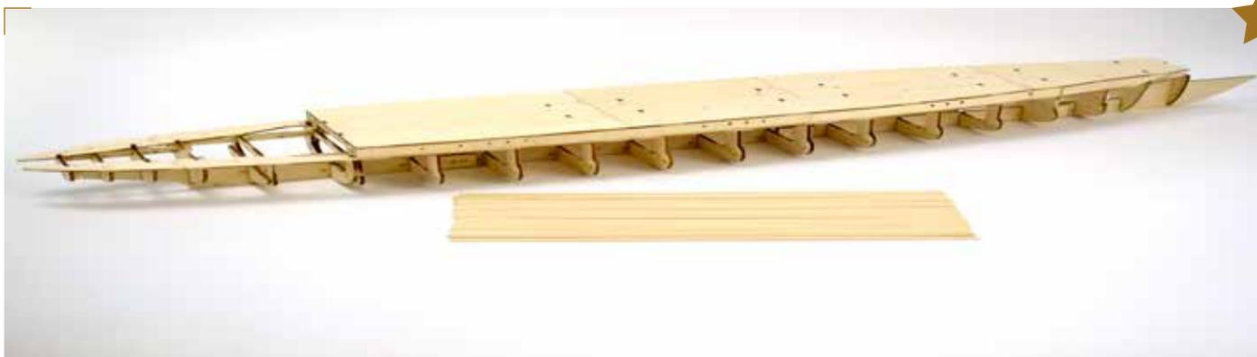
**1.** В этом выпуске мы начнём обшивку корпуса. Не торопитесь заранее готовить каждую планку к установке на своё место. Мы будем приклеивать планки одну за другой, подгоняя их к корпусу, а также соединяя их поверх шпангоутов, что даст большую область контакта клея с поверхностью.
