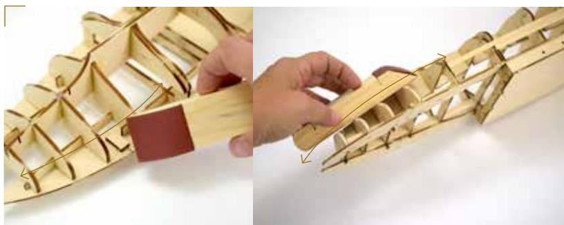
**6.** Слегка отшлифуйте края в кормовой зоне корабля (последние четыре шпангоута), чтобы улучшить контакт клея с поверхностью.
